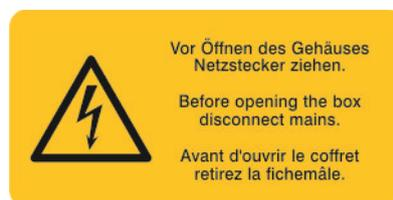
Dieses Symbol warnt davor, das Gerät zu öffnen, während eine Verbindung zum Stromnetz besteht. Bei Nichtbeachtung dieses Symbols entstehen Risiken für Personen, die an dem Gerät arbeiten oder sich in deren Nähe befinden. Des Weiteren entstehen Risiken für Sachwerte.
